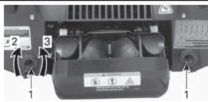
ТИПОВОЙ ВАРИАНТ — РАСПОЛОЖЕНИЕ ПРОБОК СЛИВНЫХ ОТВЕРСТИЙ
