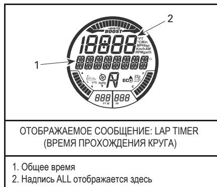
Для сброса таймера и счетчика кругов нажмите и удерживайте кнопку SET, пока показания таймера и счетчика не обнулятся.
