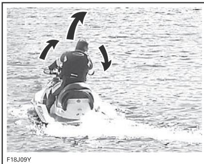
Перекладка руля приводит к повороту сопла водомета в горизонтальной плоскости. Перекладка руля вправо приведет к повороту гидроцикла вправо, и наоборот. Во время выполнения поворота следует нажимать рычаг дроссельной заслонки.
