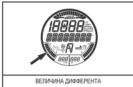
Система позволяет вручную регулировать дифферент, выбирать одну из двух предварительных установок, а также изменять настройки предварительных установок.
