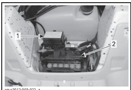
ТИПОВОЙ ВАРИАНТ - ПАНЕЛЬ ДОСТУПА АКБ СНЯТА
